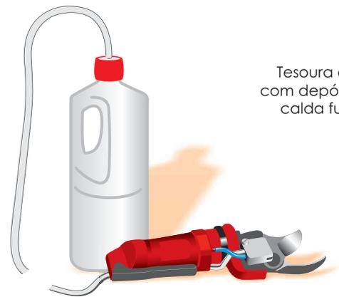
Tesoura de poda com depósito para calda fungicida.
